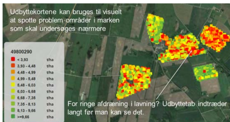
Figur 1 Eksempel på udbyttekort i græs fra Claas Telematics (Tjele Maskinstation). Bruges til at spotte områder i markerne med lavt udbytte hvor årsagen bør undersøges nærmere.
