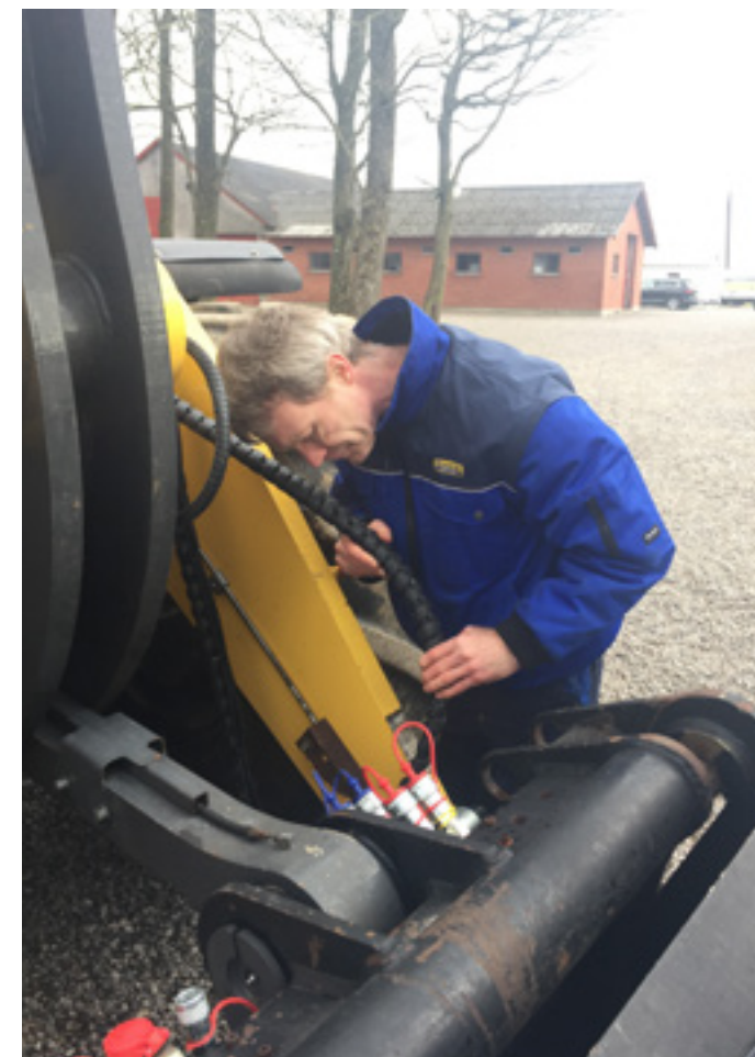
Morten tjekker om isoleringen på slangerne skraller af
